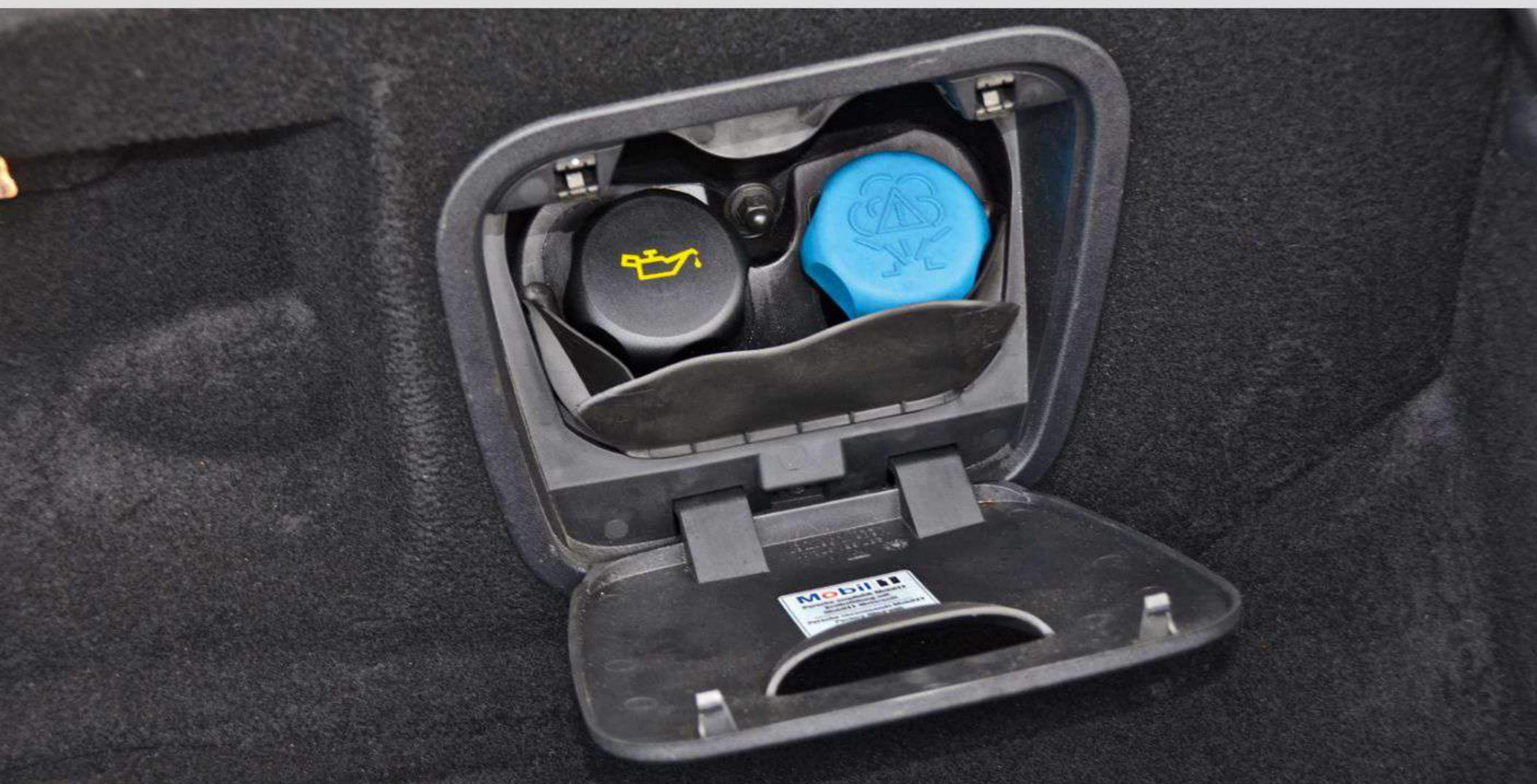
Extrem praktisch, aber für Technikfreaks völlig unsexy: Die Einfüllstutzen für Öl und Wasser im Kofferraum sind alles, was man vom Triebwerk sieht.
