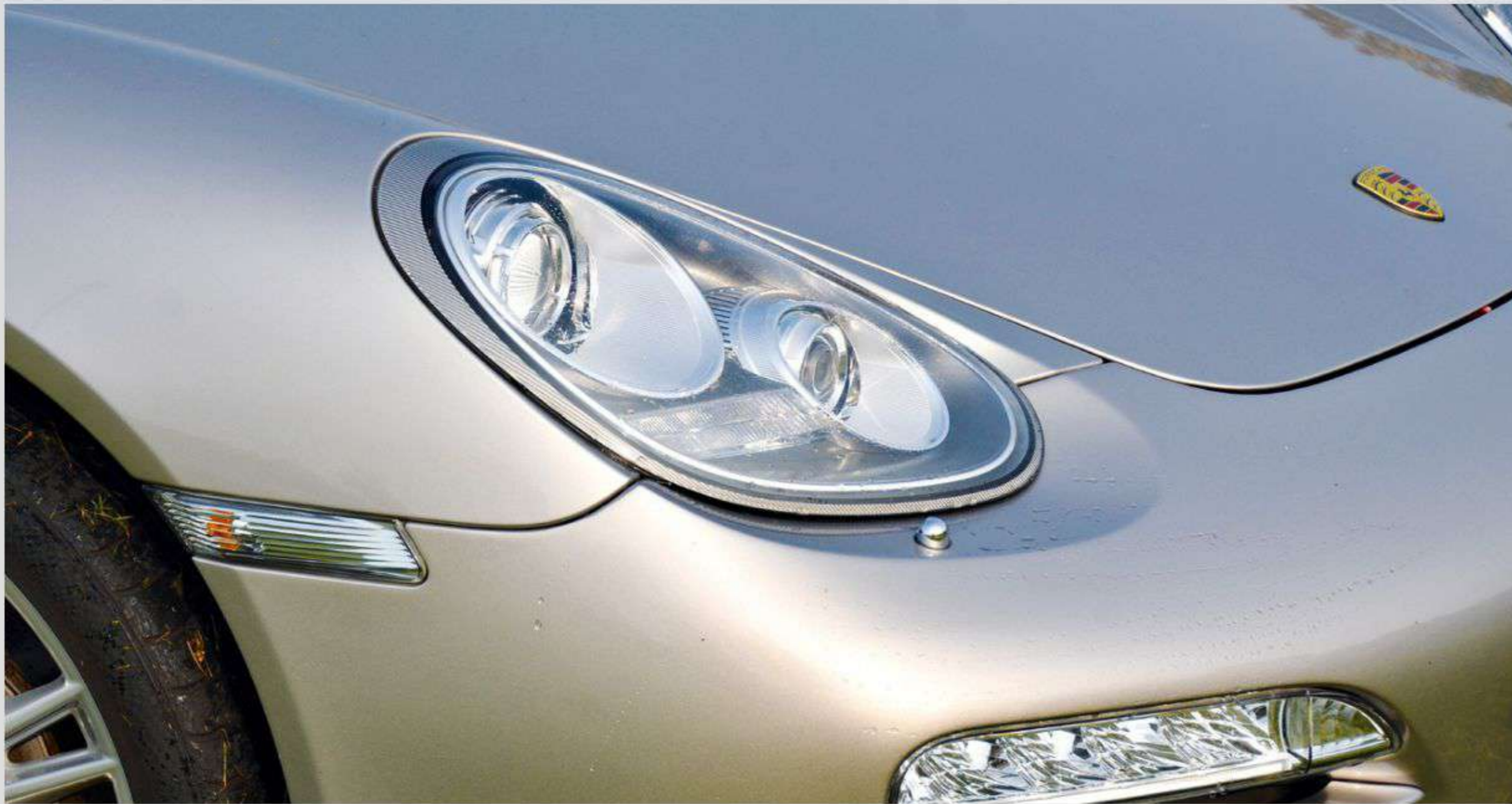
Xenon-Scheinwerfer sorgen für eine hervorragende Fahrbahnausleuchtung, in der Stoßstange das LED-Tagfahrlicht.
