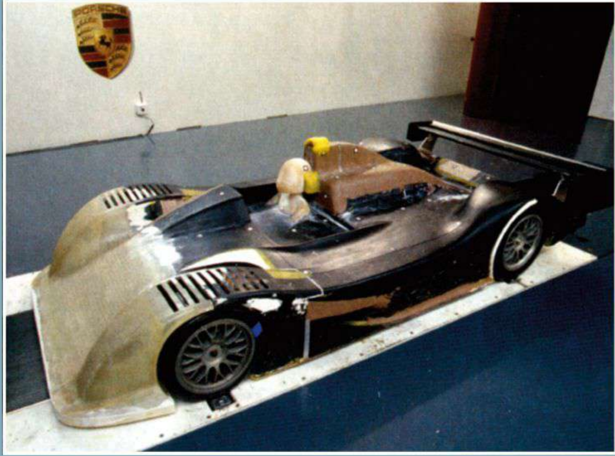
Im Windkanal in Weissach wurden Aerodynamikversuche mit offenen Modellen im Maßstab 1:4 unternommen.
