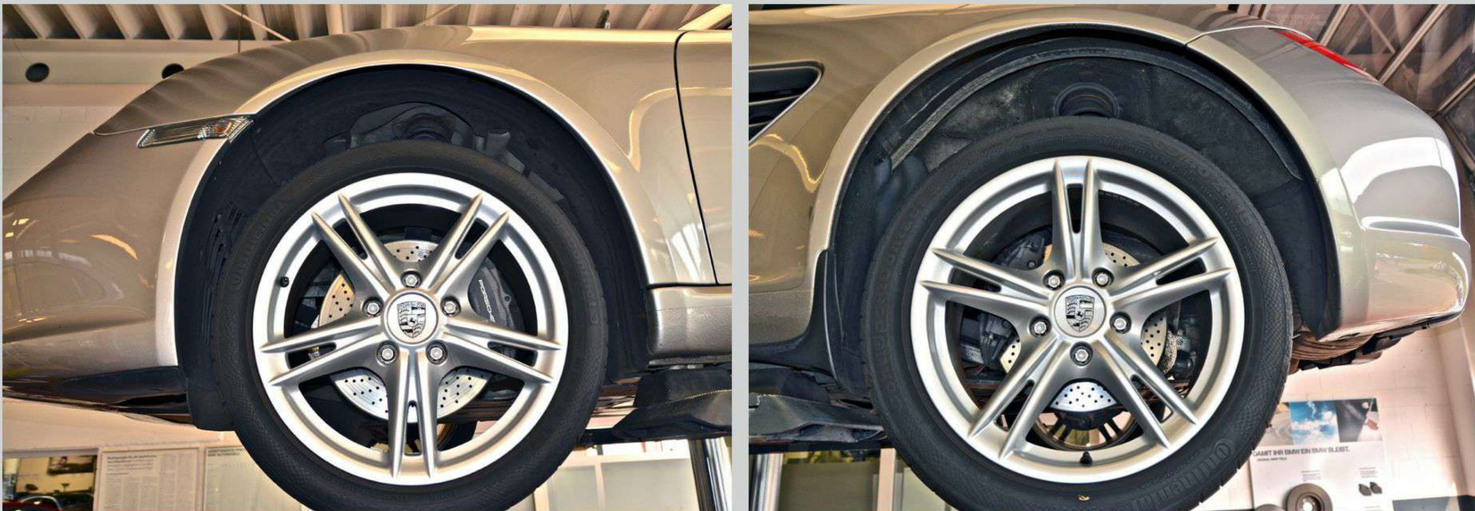
Dieser 987 trägt die optionalen 18-Zoll-Räder des Boxster S mit Reifen im Format 235/40 ZR 18 und 265/40 ZR 18.
