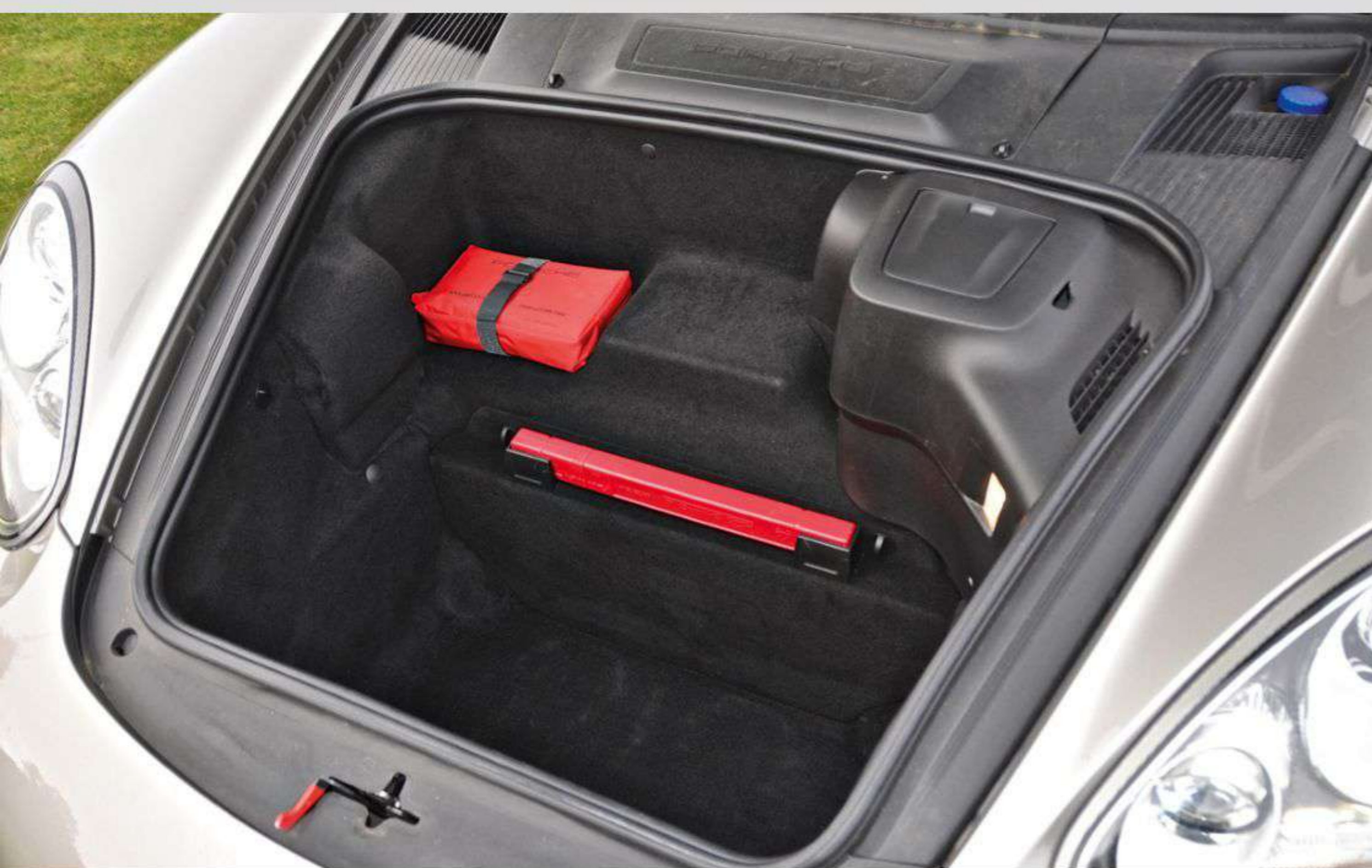
Extrem praktisch, aber für Technikfreaks völlig unsexy: Die Einfüllstutzen für Öl und Wasser im Kofferraum sind alles, was man vom Triebwerk sieht.
